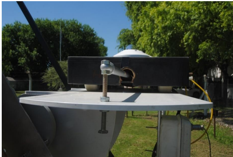
Figura 8; extremo del actuador lineal (situado debajo del carro) que permite ubicar al carro en las dos posiciones de medición.
