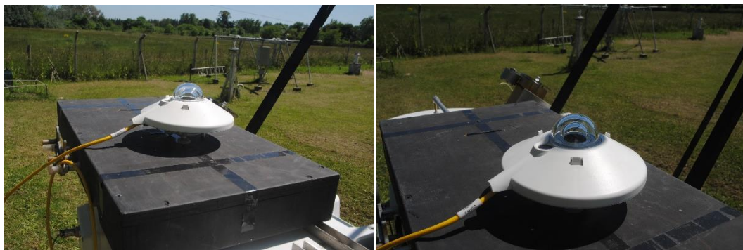
Figura 6: Solarímetro en las dos posiciones que toma el carro: destapado (izquierda) y tapado (derecha)
