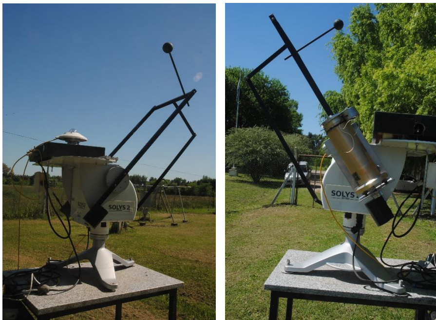
Figuras 3 y 4: Seguidor Solys 2. En la foto de la izquierda puede verse el solarímetro montado sobre el carro. A la derecha, pirheliómetro TMI montado sobre el seguidor.
